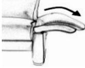
Alle Armlehnenvarianten können mit einer Abklappfunktion ausgestattet werden. Hierfür wird ein Klemmbeschlag eingesetzt.
